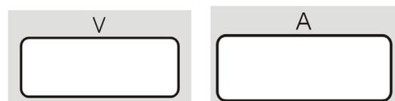
El medidor derecho muestra la corriente de soldadura predefinida (A) antes de soldar y la corriente real de soldadura durante el trabajo. El medidor izquierdo muestra la tensión (V) en los cables de la salida. La pantalla muestra un parpadeo que indica que el valor leído es la corriente media durante la operación de soldadura anterior. Esta función muestra el valor medio durante 5 segundos después de finalizado el tiempo de soldadura.
