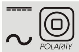
Este icono permite definir el tipo y polaridad de la corriente del proceso de soldadura empleado: CC+, electrodo revestido en CA, TIG en CC y en CA.
