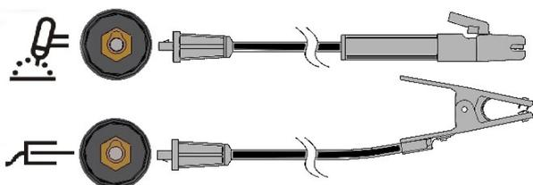
Conecte el cable del electrodo al conector de la antorcha y el cable de la pinza de masa al conector de la masa. Inserte el enchufe con la guía alineada con la ranura y gire aproximadamente ¼ de vuelta en el sentido de las agujas del reloj. No apriete en exceso.
