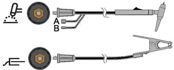
Conecte el cable de la antorcha al conector para la antorcha de la máquina y el cable de masa al conector para masa. Inserte el enchufe con la guía alineada con la ranura y gire aproximadamente ¼ de vuelta en el sentido de las agujas del reloj. No apriete en exceso. Finalmente,
