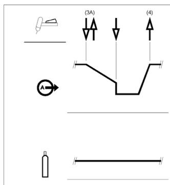
Como se puede ver aquí, después de apretar y soltar rápidamente otra vez el gatillo de la antorcha TIG en el paso 3A es posible pulsar y soltar rápidamente el gatillo de la antorcha TIG una vez más para finalizar el tiempo de la pendiente descendente y dejar de soldar.
