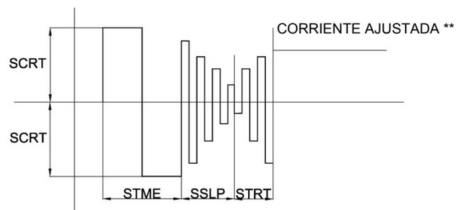
La secuencia de arranque también cambia si hay un pedal de control conectado: de hecho, considerando que el nivel STRT no se puede ajustar, el nivel al final de la pendiente SSLP es el nivel establecido por el pedal de control o el nivel PCRT.
