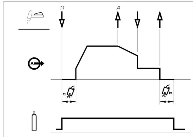
Como muestra la siguiente gráfica, si se pulsa y mantiene apretado el gatillo de la antorcha TIG por segunda vez durante la pendiente descendente, finalizará la pendiente y la corriente de salida se mantendrá con el valor de la corriente de cráter. Si se suelta el gatillo, la salida se apagará y comenzará el tiempo del postflujo de gas. Esta secuencia de funcionamiento de 2 pasos con reinicio desactivado es el ajuste predefinido en fábrica.
