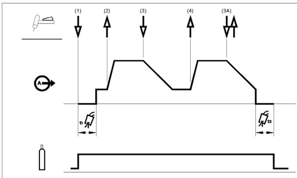
3. Pulse y mantenga presionado el gatillo de la antorcha TIG. Ahora la máquina reducirá la corriente de salida a una tasa controlada, o tiempo de la pendiente descendente, hasta alcanzar la corriente de cráter.
