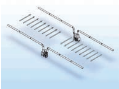
Sistema Doble paralelo push/pull con 2 filtros y 2 ventiladores.
