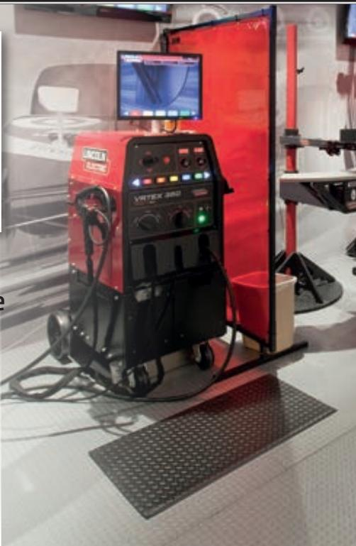
Conecte un proyector o una pantalla grande al VRTEX® y así una clase entera podrá ver lo que ve el soldador bajo la pantalla de soldadura. Esto conlleva un sentido de trabajo en equipo para el proceso de aprendizaje y aumento de la comprensión a través de la interacción. Múltiples puntos de vista muestran una medición precisa en tiempo real de las variables clave, tales como boquilla de contacto, distancia a la pieza, ángulo de trabajo, ángulo desplazamiento, velocidad y posición.
